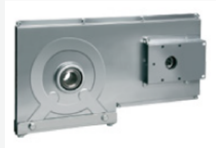
Bandiera imbutita lato motore La bandiera è parte integrante del sistema di sollevamento e alloggia al suo interno l'ultimo rapporto di trasmissione: Pignone, corona e catena. Rapporto di trasmissione 1:5 cod. 76150001
