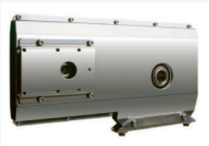
Bandiera imbutita lato motore La bandiera è parte integrante del sistema di sollevamento e alloggia al suo interno l'ultimo rapporto di trasmissione: Pignone, corona e catena. Rapporto di trasmissione 1:7 cod. 76170000
